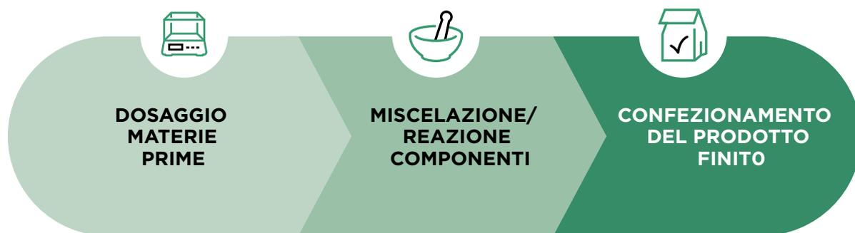
In estrema sintesi, il **ciclo tecnologico-produttivo** di Mapei consiste nelle fasi di dosaggio di materie prime (liquide o in polvere), miscelazione o reazione dei componenti e successivo confezionamento del prodotto finito.
