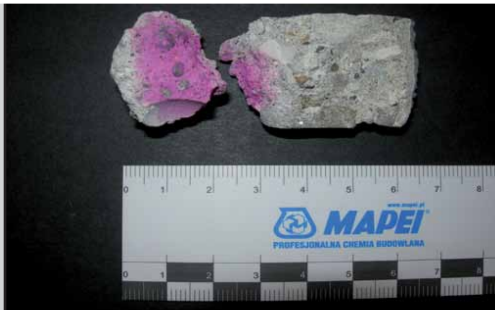
foto 6 Esame colorimetrico con fenolftaleina
