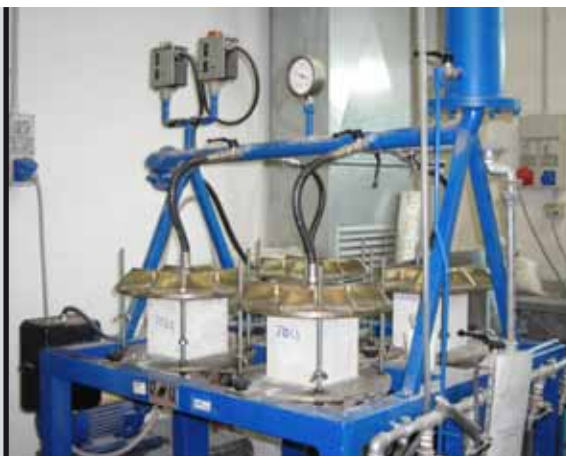
foto 9 Attrezzatura per l'esecuzione della prova d'impermeabilità all'acqua
