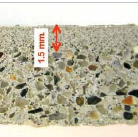
Fig. 8.11 - Applicazione di PRIMER MF sulla superficie di un massetto
