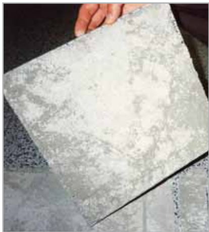
Fig. 3.4 - Distacco di ceramica su massetto polveroso
