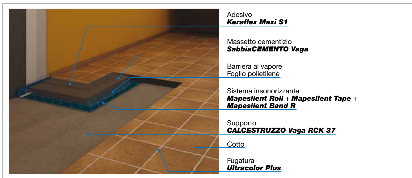
Fig. 4.3.2 - Massetto galleggiante isolato acusticamente con SISTEMA MAPESILENT
