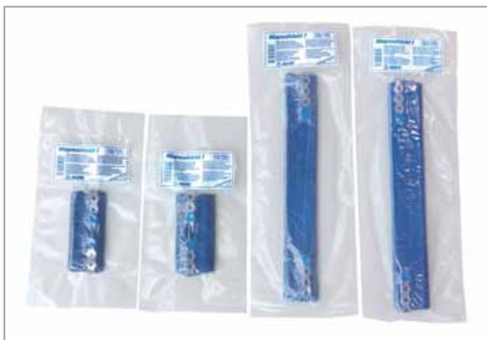
**Mapeshield I**, anodi di zinco puro rivestiti da una speciale pasta conduttiva, per la protezione catodica galvanica dei ferri d'armatura dalla corrosione, nelle strutture nuove o da ripristinare. **Mapeshield I** deve essere fissato alle armature prima del ripristino realizzato con le malte della linea **Mapegrout**, oppure prima di effettuare i getti di calcestruzzo nel caso di nuove realizzazioni.
