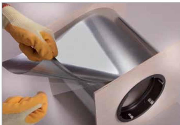
**Mapeshield E 25**, lamina di zinco autoadesiva, da applicare direttamente sulla superficie esterna della struttura, per la protezione catodica galvanica dei ferri d'armatura al fine di prevenire o bloccare la corrosione. **Mapeshield E 25** deve essere collegata alle armature mediante un semplice cavetto metallico, in modo da rendere il sistema attivo.
