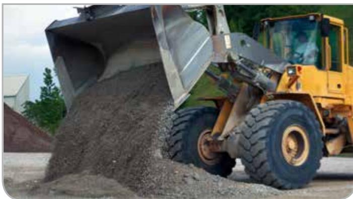
Dopo pochi minuti di miscelazione con **RE-CON ZERO** oppure **RE-CON ZERO EVO**, il calcestruzzo è trasformato in un materiale granulare che può essere scaricato a terra e, dopo maturazione, utilizzato come aggregato per calcestruzzo. **RE-CON ZERO** oppure **RE-CON ZERO EVO** funzionano su tutti i tipi di calcestruzzo.
