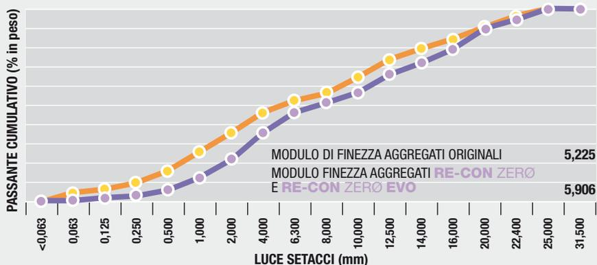
Gli aggregati **RE-CON ZERO** e **RE-CON ZERO EVO** soddisfano i requisiti previsti dalla norma EN 12620:2008 "Aggregati per il Calcestruzzo".
