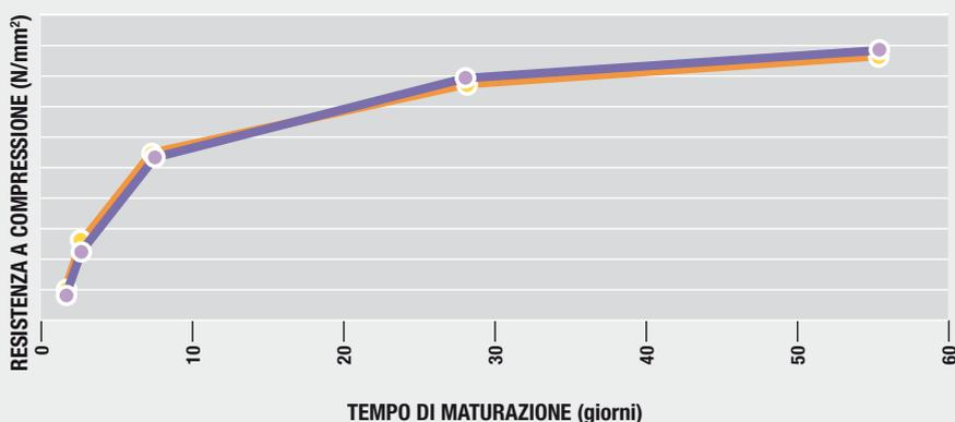
Gli aggregati **RE-CON ZERO** e **RE-CON ZERO EVO** possono essere utilizzati per produrre il calcestruzzo in parziale sostituzione dell'aggregato grosso (fino al 50%).
