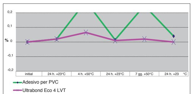
Risultati di test di stabilità dimensionale effettuati, in accordo alla norma EN 1903, su campione di LVT in doghe, con **Ultrabond Eco 4 LVT**, in comparazione ad adesivo generico per PVC.
