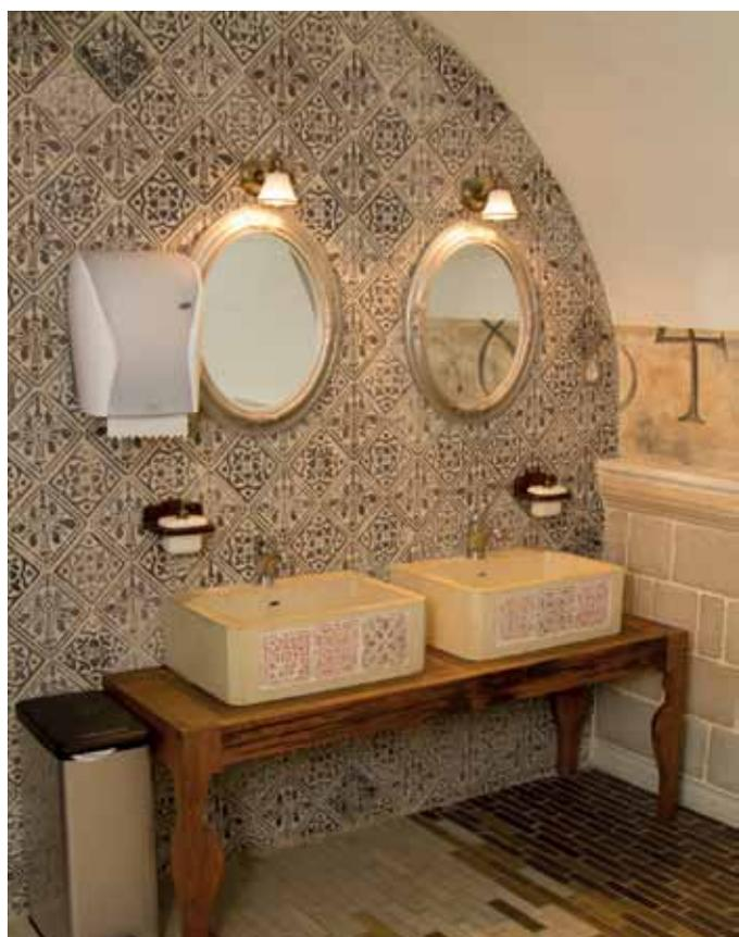
**A DESTRA.** Per ottenere un effetto satinato, per il trattamento finale delle piastrelle sono state utilizzate le cere protettive MAPELUX OPACA e MAPELUX LUCIDA, miscelate insieme.
