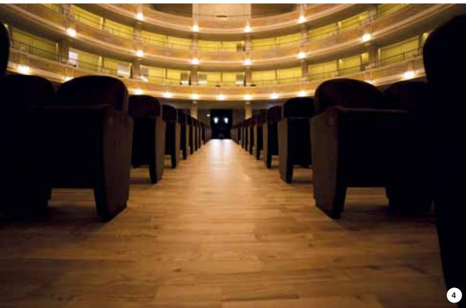
**FOTO 4.** Il parquet in rovere nella platea e nei tre ordini è stato posato con ULTRABOND ECO S955 1K, adatto per pavimenti radianti.
