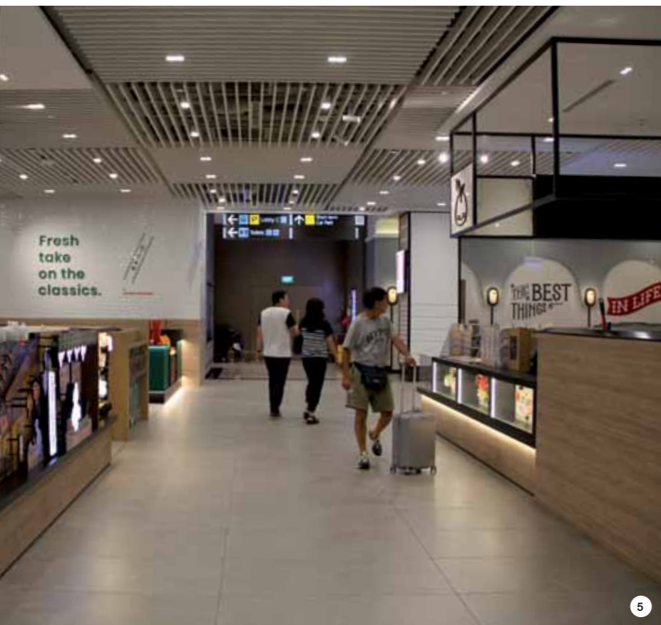
5. La zona ristorazione è stata rivestita con piastrelle ceramiche posate con KERAFLEX e stuccate con KERACOLOR SF. 6. Il granito nero nei bagni è stato incollato con GRANIRAPID e stuccato con KERACOLOR SF. I supporti sono stati preventivamente trattati con PRIMER G.
