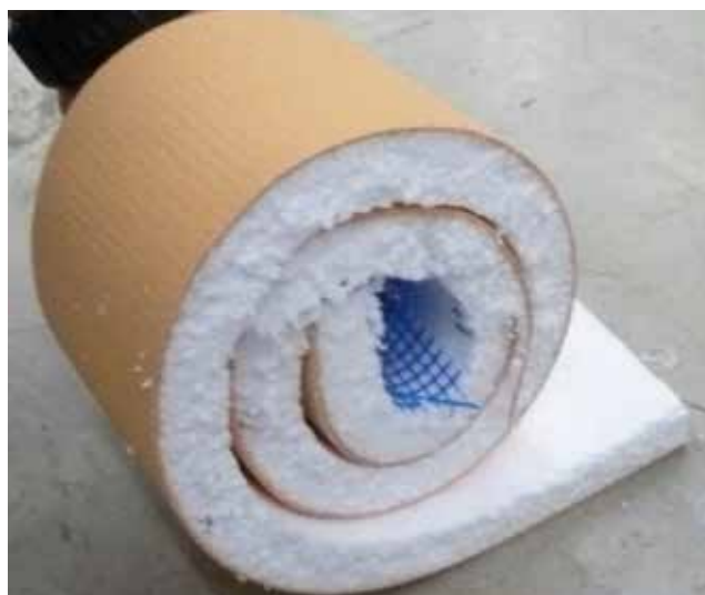
Próbka o wymiarach 50 x 15 x 2 cm wykonana z: EPS; MAPETHERM FLEX PL 0,5 mm; MAPETHERM NET 150
