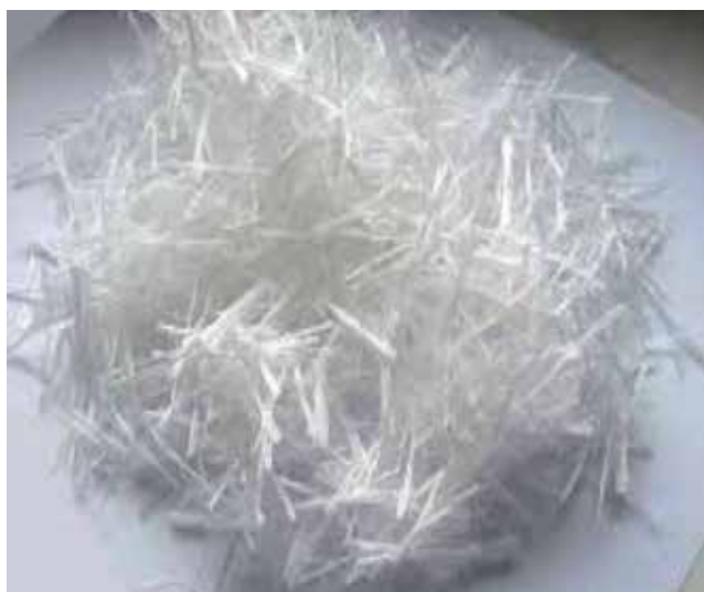
Włókna wzmacniające poprawiające odporność powłoki na uszkodzenia mechaniczne
