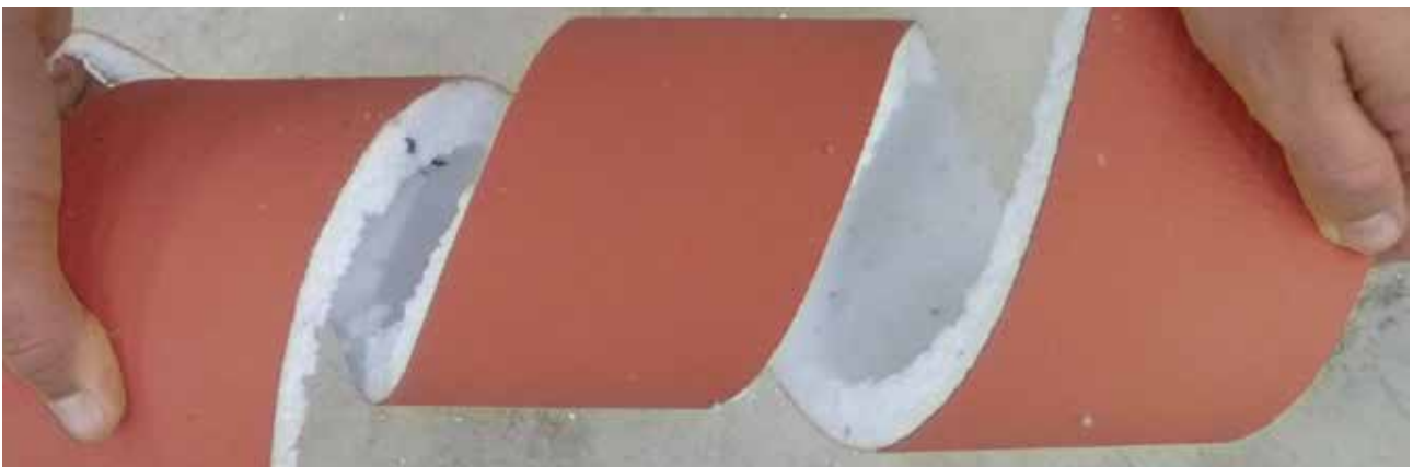
Próbka o wymiarach 50 x 15 x 2 cm wykonana z: EPS; MAPETHERM FLEX PL 0,5 mm; MAPETHERM NET 150
