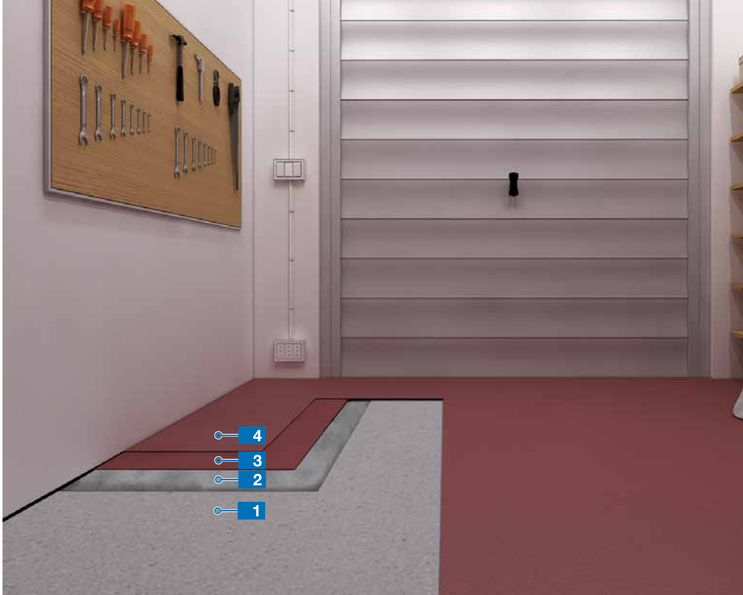
System posadzek na bazie żywicy epoksydowej w parkingach podziemnych
