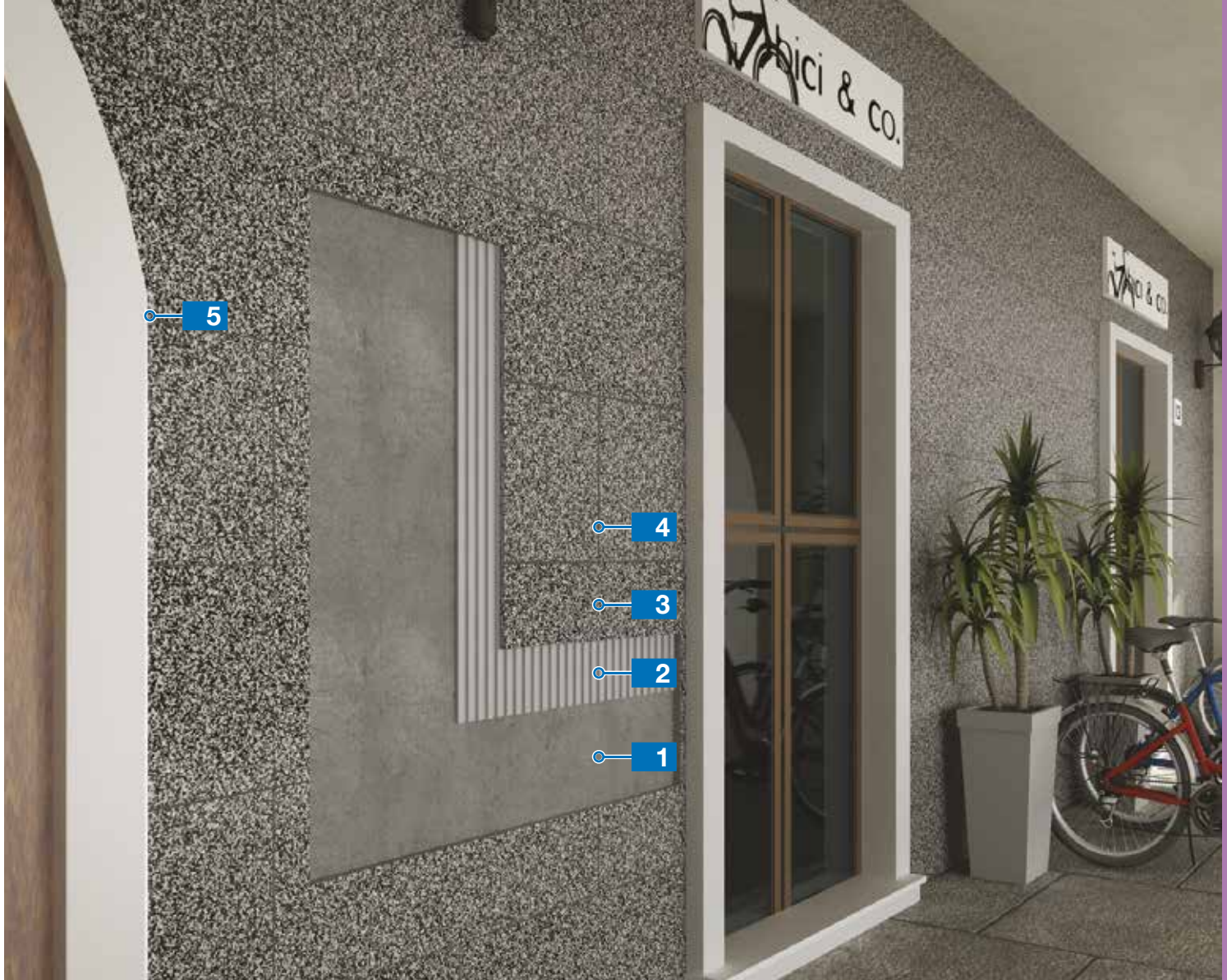
System montażu wielkoformatowych płytek z kamienia naturalnego na elewacjach
