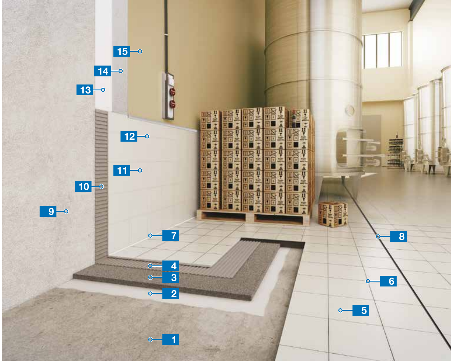
System montażu ceramiki w pomieszczeniach poddawanych silnym obciążeniom i narażonym na działanie czynników chemicznych
