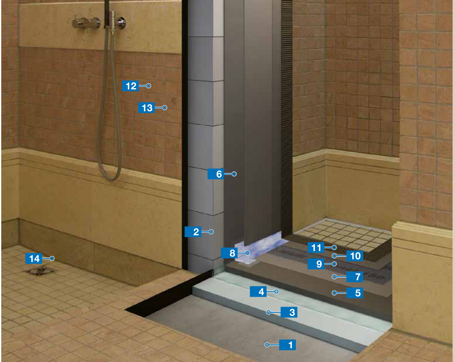
Szybki system montażu kamienia naturalnego w pomieszczeniach wilgotnych
