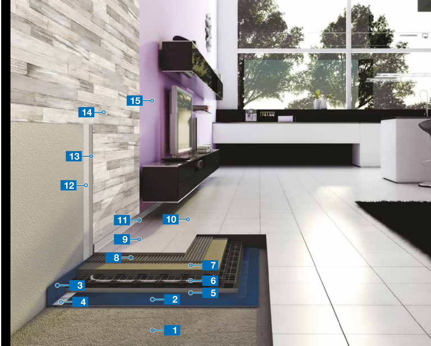
System montażu ceramiki na podkładach cementowych z ogrzewaniem podłogowym
