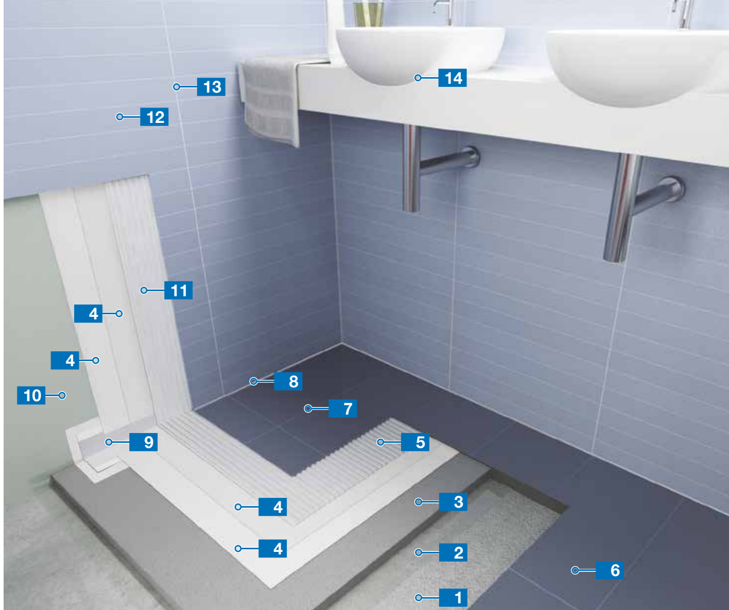
System hydroizolacji i montażu ceramiki w łazienkach i strefach mokrych
