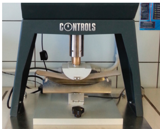
3. Разрушение опытного образца
