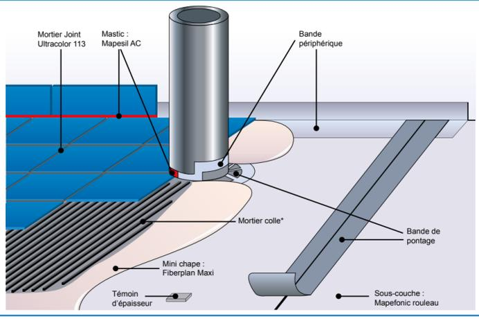
Fig 10 : Traitement d'une traversée de canalisation sur support bois avec réalisation d'un socle
