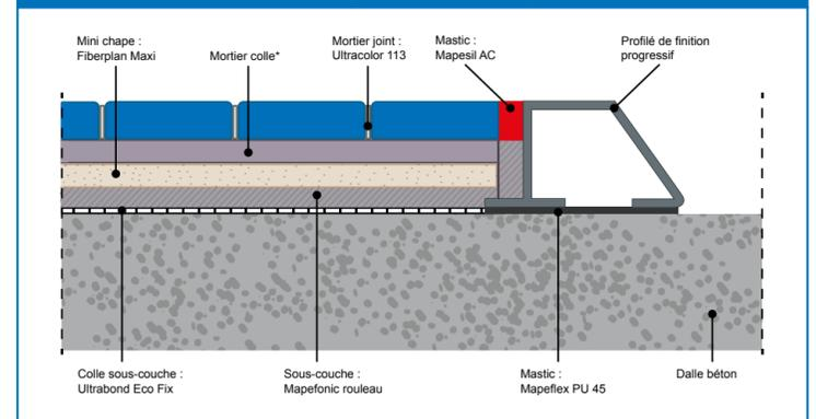
Fig 5 : Traitement des seuils : cas d'un parquet dans le local adjacent
