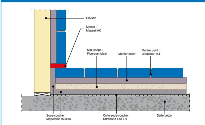
Fig 2 (bis) : Traitement de la jonction sol/mur avec relevé de la sous-couche
