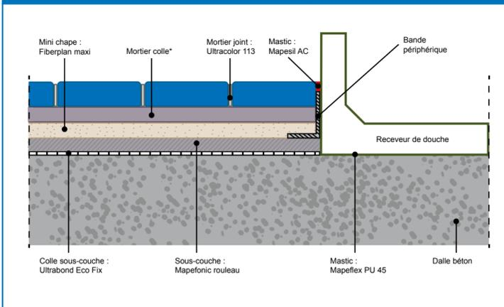
Fig 2 : Traitement de la jonction sol/mur avec la bande périphérique
