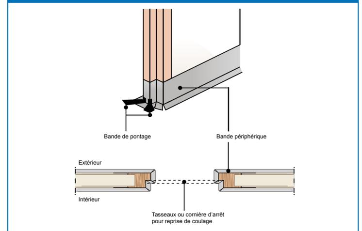
Fig 4 : Traitement des seuils de porte : cas d'un revêtement de sols souples dans le local adjacent
