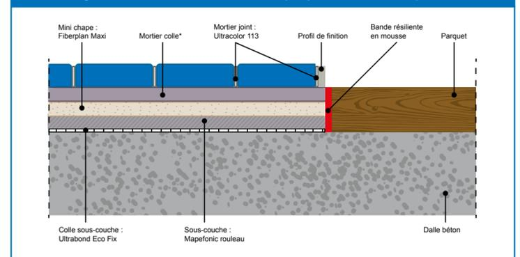
Fig 6 : Traitement des seuils : cas d'un carrelage dans le local adjacent
