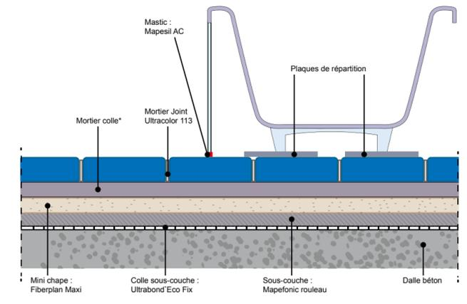
Fig 7 (bis) : Pose de baignoire sur support maçonné : cas d'une allège amovible
